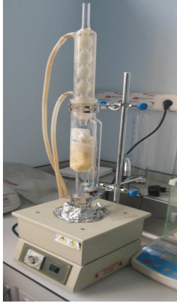
Şekil 6. Soxhlet cihazında ekstraksiyon işlemi
