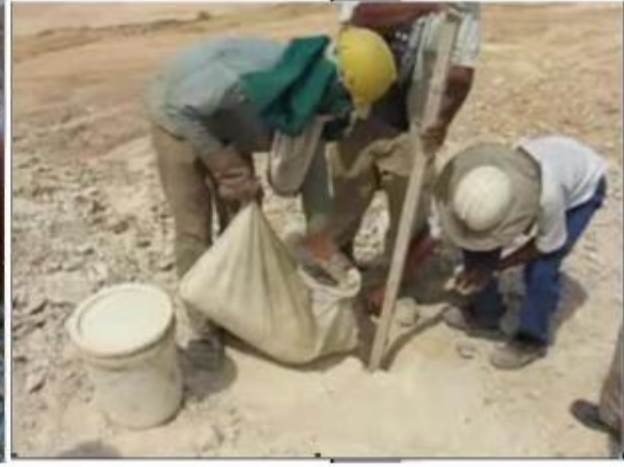
Şekil 2.19. Gübre ve mazot karışımının hazırlanması ve karışımın deliklere doldurulması
